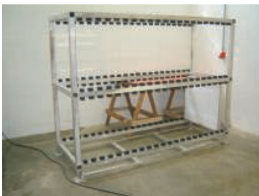
Substituição de bandeja inteira de fibra, por três bandejas fabricadas na BMB
